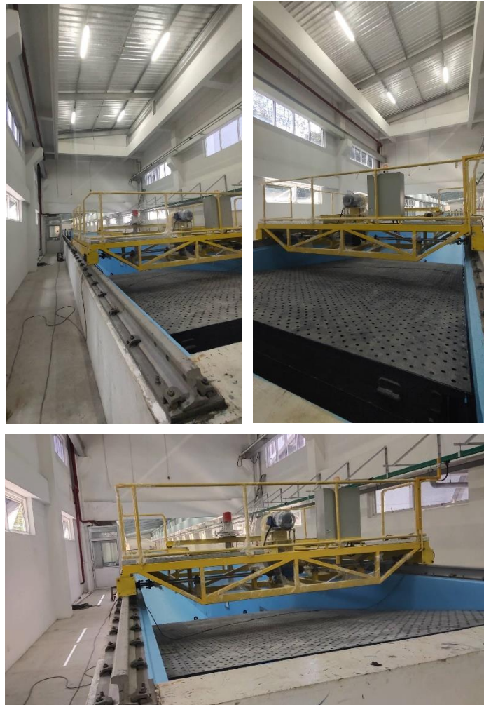
ชุดปฏิบัติการทดสอบถังลากเรือจำลอง (Towing Tank)
